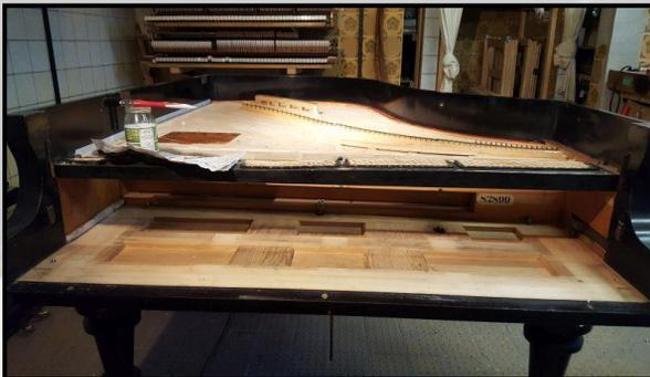
Die (Schnellschliff-) Grundierung wird doppelt aufgetragen
