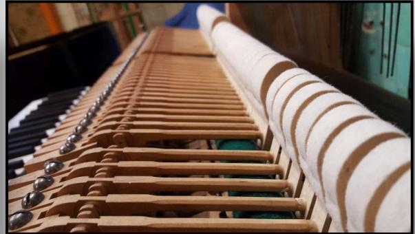
Durch das Abziehen einer Filzschicht bekommt der Hammer seine ursprüngliche Form
