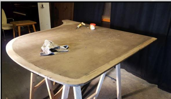
Die Fläche wird grob geschliffen, Schadstellen werden ausgekittet
