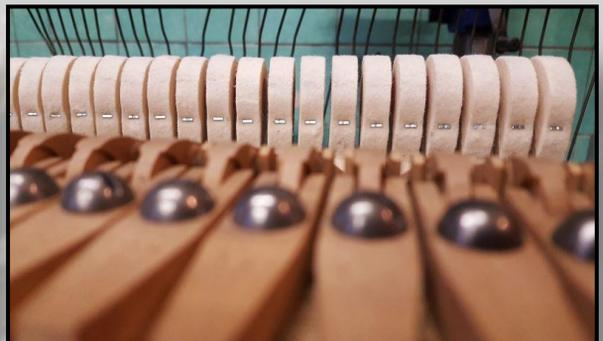
Zudem werden die Hammerköpfe mit der Intonier-nadel vorgestochen, um einen weicheren, dynamischeren Klang zu erreichen
