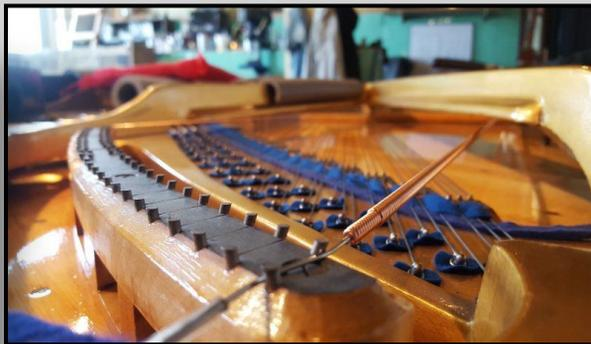
Die neuen, nach Maß angefertigten Basssaiten werden aufgezogen
