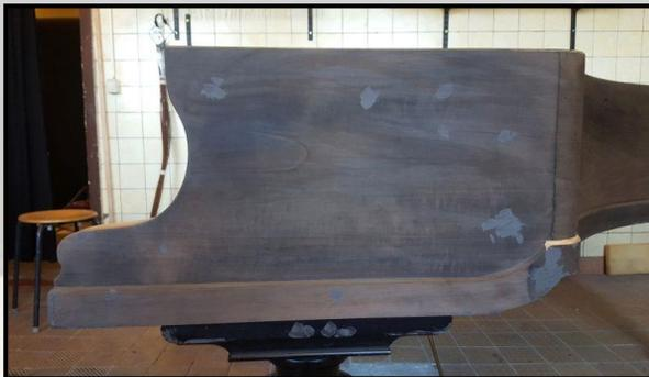
Der alte Lack wird komplett geschliffen und die
