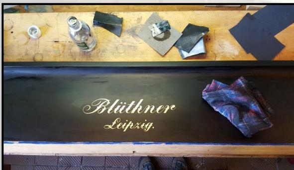
Klappe wird gebeizt, grundiert und mit Öl feingeschliffen
