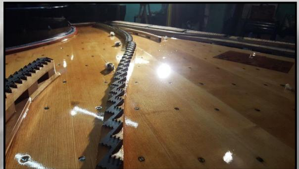
Danach wird der Boden dreifach lackiert (mit je einer Woche Trocknungszeit)
