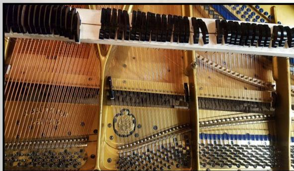
Dämpferproben werden ins Instrument eingesetzt, das richtige Ausheben wird eingestellt
