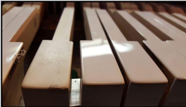
Elfenbein-Klaviatur wird leicht angeschliffen und poliert (links: unbehandelt)
