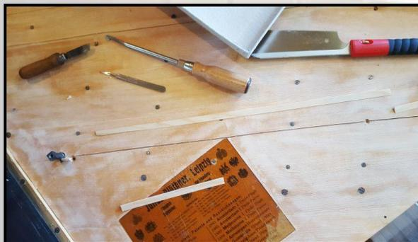
Fichtenspäne werden in die Risse eingepasst..
