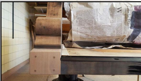
Schraubenlöcher werden ausgedübelt, Schadstellen verkittet und alles bündig geschliffen
