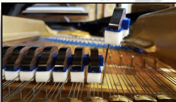
Dämpfer werden eingesetzt, gerichtet und das gleichzeitige Abheben (Zappeln) bei getretenem Pedal wird eingestellt
