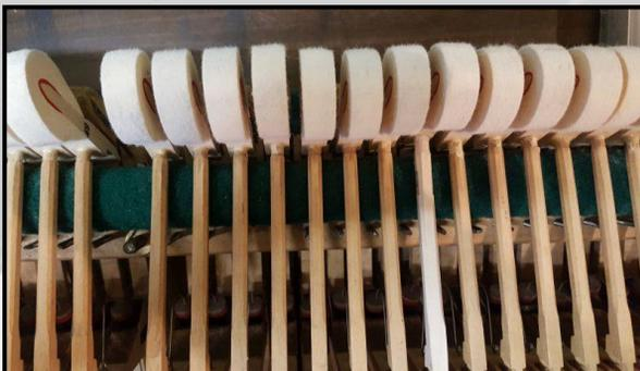
Die Hämmer werden aufs Saitenchor gerichtet und der richtige Lauf und Durchgang wird eingestellt
