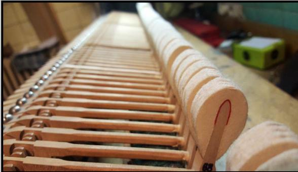
Durch häufiges Anschlagen an den Saiten entstehen Rillen am Scheitel des Hammerkopfes
