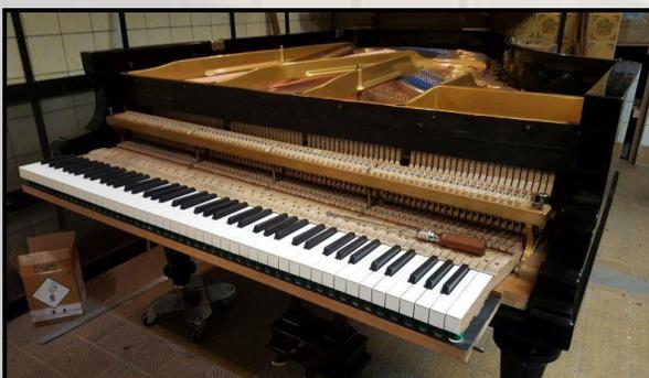
Danach wird die Mechanik wieder ins Instrument eingebaut und reguliert (gleichmäßiges Spielgefühl wird eingestellt)
