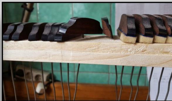
Die Filze werden restlos vom Dämpferglied entfernt
