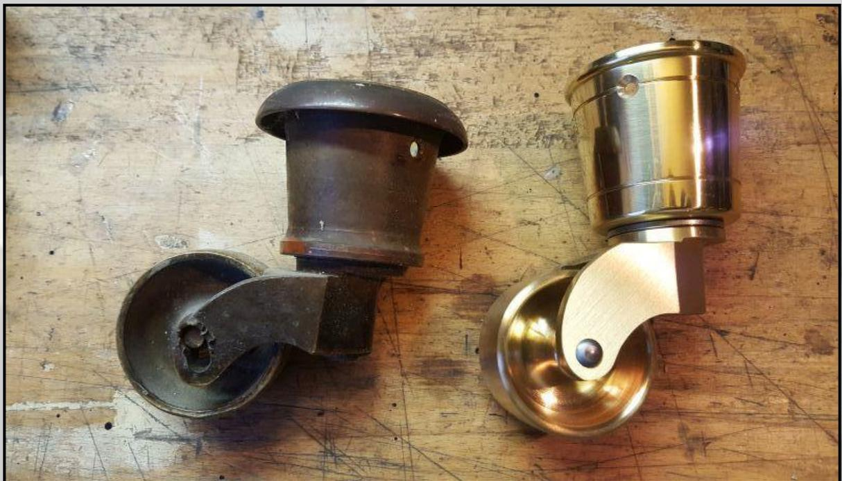
Defekte Flügelrolle hinten wird ersetzt
