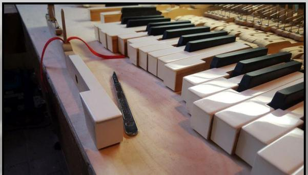
Neue Garnierungsfilze werden eingeleimt, wodurch die Taste wieder eine sichere Führung bekommt
