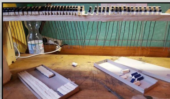
Neue Dämpfung wird aufgeleimt
