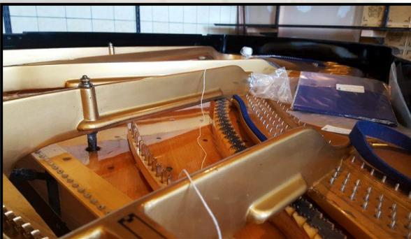
Die Gussplatte wird neu eingepasst, der Stegdruck wird eingestellt und die Garnierungsfilze werden erneuert
