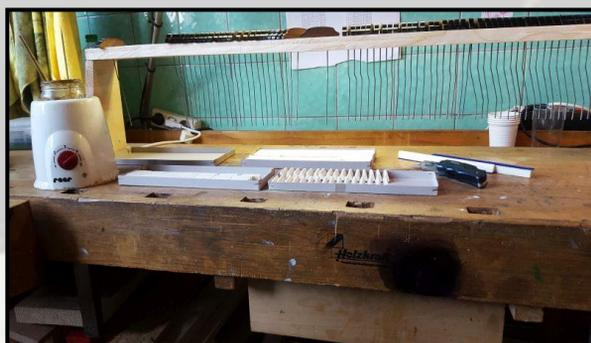
Neue Filze werden vorbereitet, Glutinleim wird erwärmt
