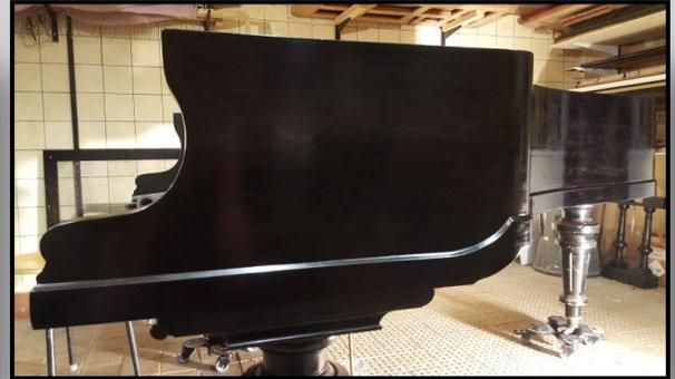
Im Anschluss werden ca. 6 Schichten Schellack schwarz im Polierverfahren aufgetragen
