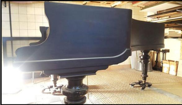
Grundierung wird 3-fach aufgetragen, dann wird die Fläche sehr fein nassgeschliffen
